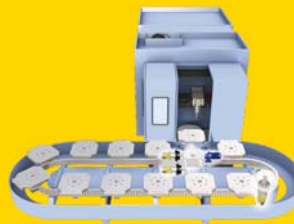
Werkzeugmaschine: Palettenwechsler Machine tool: Pallet changer
